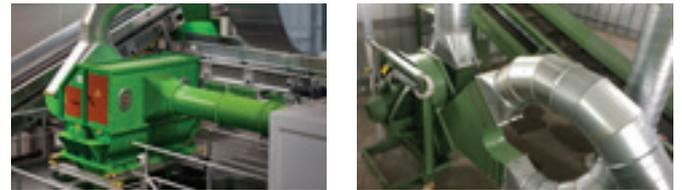
Diverse Einstellmöglichkeiten gewährleisten die Anpassung des Nierensichters an verschiedene Kundenanforderungen. Der Nierensichter kann problemlos in bestehende Windsichteranlagen integriert werden, um deren Effizienz deutlich zu verbessern.
